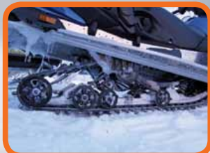
Pro Comfort-understell med HP-gassdempere. Ikke GT-nivå, men funker greit nok
